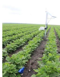
Pour garantir un pilotage optimal de l'irrigation, les sondes de mesure d'humidité du sol sont devenues durant ces dernières années des outils incontournables. Des seuils référencés existent aujourd'hui sur de nombreux sols et de nombreuses cultures. De 400 € HT à plus de 4 000 € HT, un large panel d'équipements est à votre
